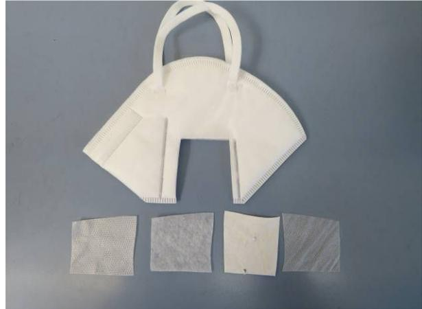
Bild 8 Atemschutzmaske aufgetrennt
